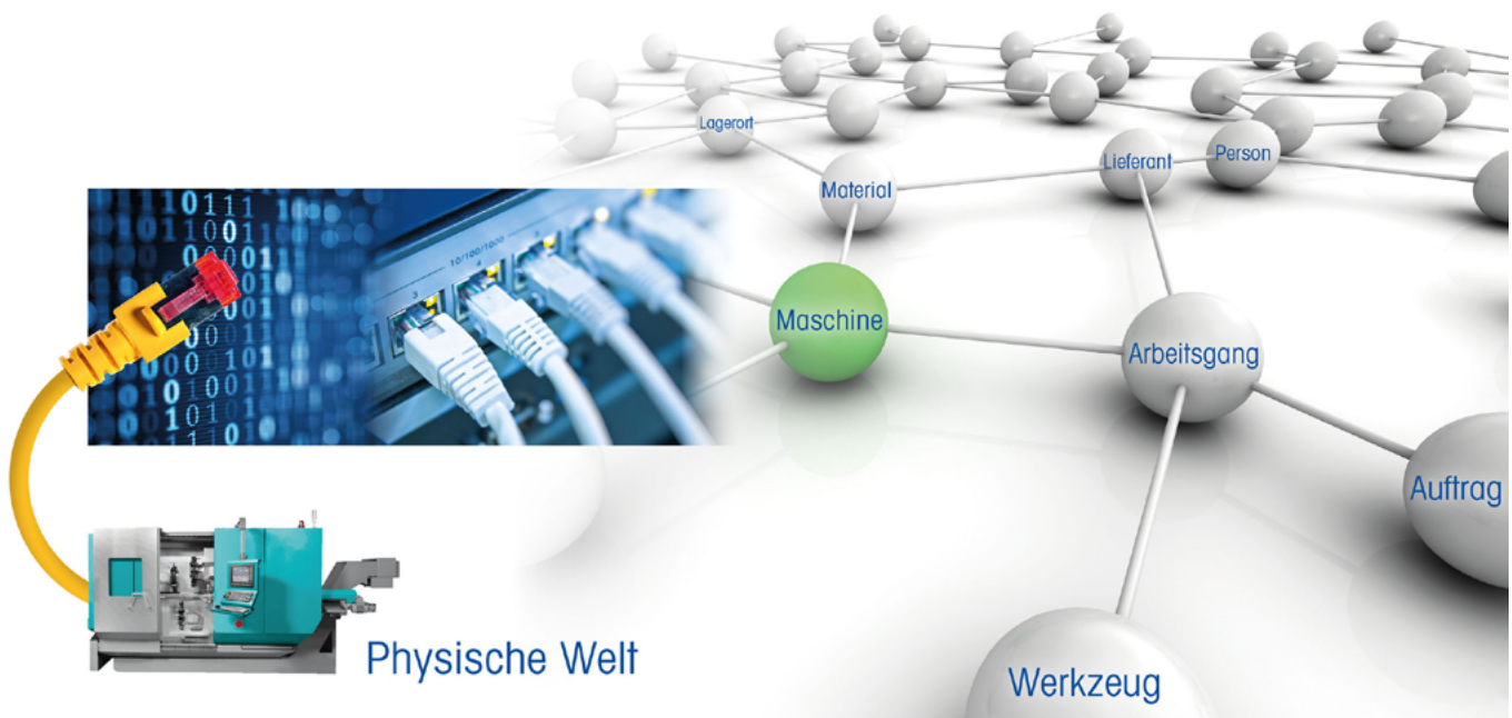
Abbildung 3-10: Darstellung der Verbindung zwischen dem physischen Asset (Maschine) über den Netzwerkstecker mit dem Internet/Netzwerk und damit der MIP, speziell der ViPR und der Kontextbildung in der ViPR für den digitalen Zwilling des physischen Assets
